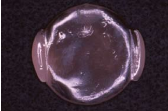
FIGURA 6 – Corpos-de-prova do material COE-SOFT, após 3 meses de armazenagem, (A) sem desinfecção química e (B) com desinfecção química, apresentando muita porosidade.
