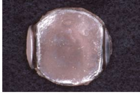
FIGURA 6 – Corpos-de-prova do material COE-SOFT, após 3 meses de armazenagem, (A) sem desinfecção química e (B) com desinfecção química, apresentando muita porosidade.
